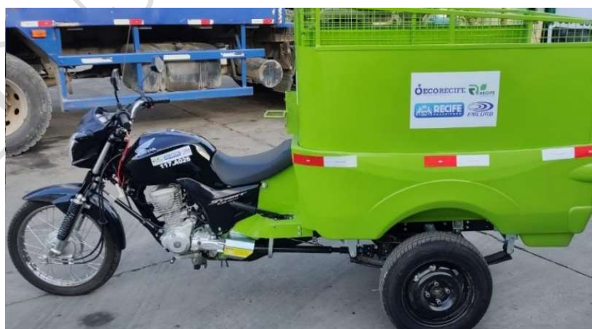
Figura 33: Moto Triciclo para coleta satélite/Recife – PE
