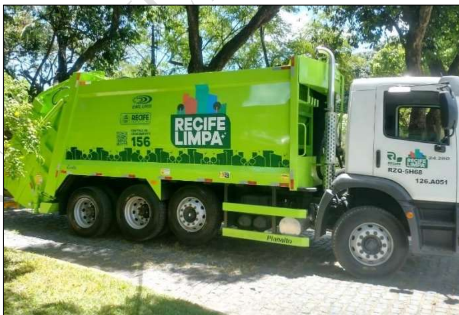
Figura 29: Caminhão utilizado para Coleta regular de RSD, Comerciais, de Varrição e Feiras Livres em Recife - PE
