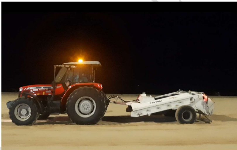
Figura 15: Serviço de limpeza de faixa de areia: trator com equipamento para peneiramento da areia e sucção de resíduos
