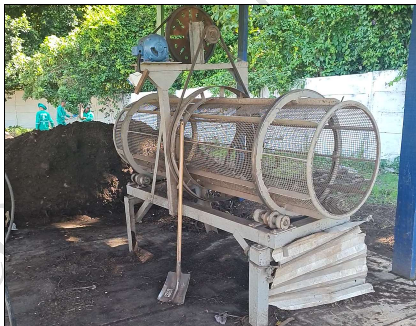
Figura 49: Peneira rotativa para peneiramento do composto maturado
