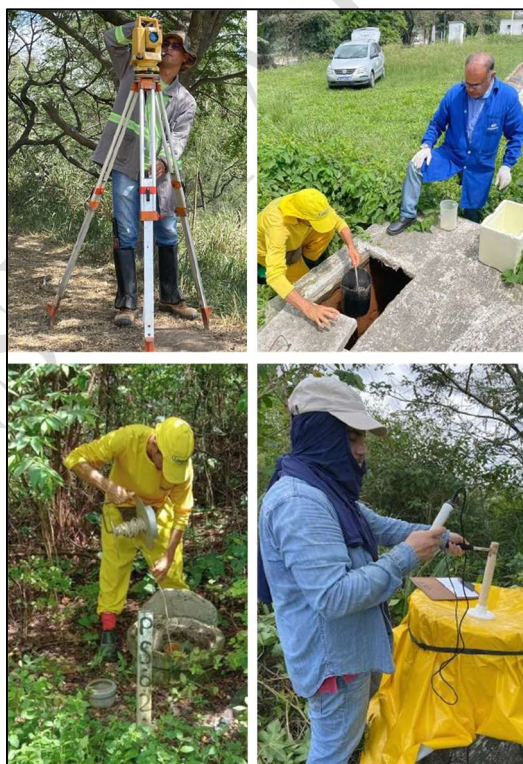
Figura 65: Atividades para a recuperação, monitoramento ambiental e manutenção do aterro encerrado da Muribeca: (a) leitura dos marcos superficiais; (b) coleta de amostra dos lixiviados; (c) inspeção dos poços de águas subterrâneas; e (d) medição concentração e vazão de biogás
